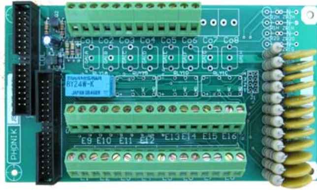
รูปที่ 4.14 แสดงการวางอุปกรณ์ของแผง JSD-TV5/6COL
