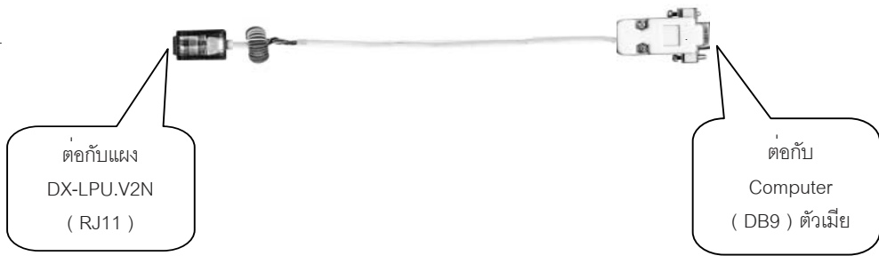
รูปที่ 13.1 ตัวอย่างสายสัญญาณ RJ11 DX ต่อกับ Computer ( DB9 )
