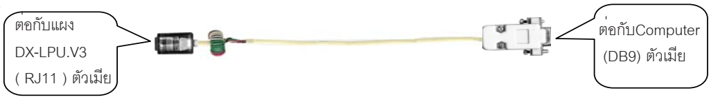
รูปที่ 11.1 ตัวอย่างสายสัญญาณ RJ11 DX ต่อกับ COM ( DB9 )
