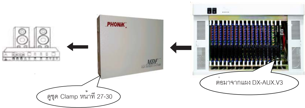
รูปที่ 7.4 แสดงการต่อ Paging ชุดออกประกาศ
