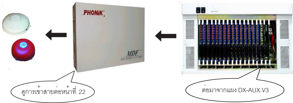
รูปที่ 7.7 แสดงการต่อ Alarm Detector , Alarm Indicator
