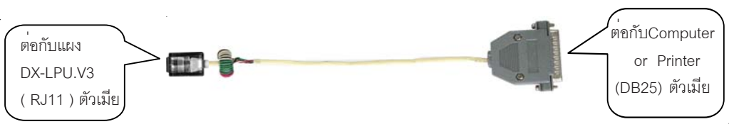
รูปที่ 11.2 ตัวอย่างสายสัญญาณ RJ11 DX ต่อกับ COM ( DB25 )
