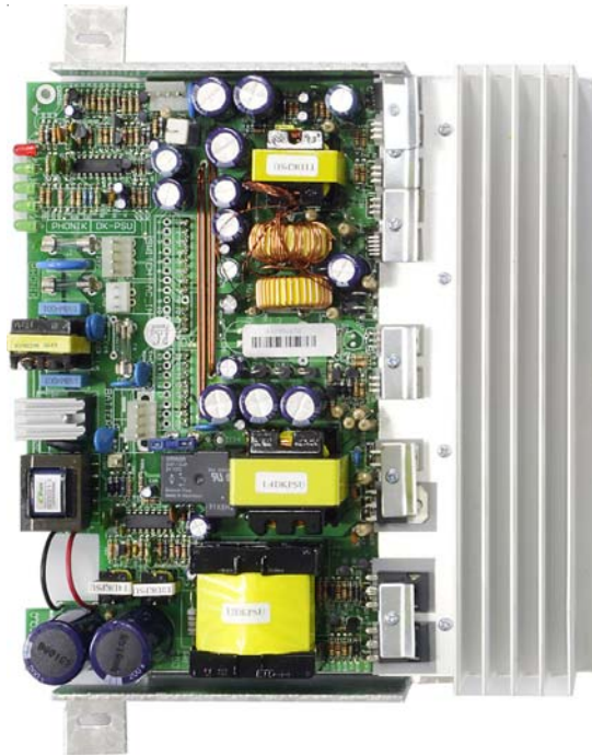
รูปที่ 4.7 แสดงการวางอุปกรณ์ของแผง DX-PSU(D)
