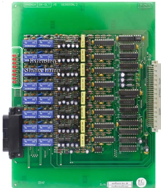
รูปที่ 5.10. แสดงการวางอุปกรณ์ของแผง DX-8SLT48/R.V2
