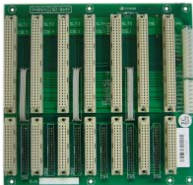
รูปที่ 4.11 แสดงการวางอุปกรณ์ของแผง JSD-B64P
