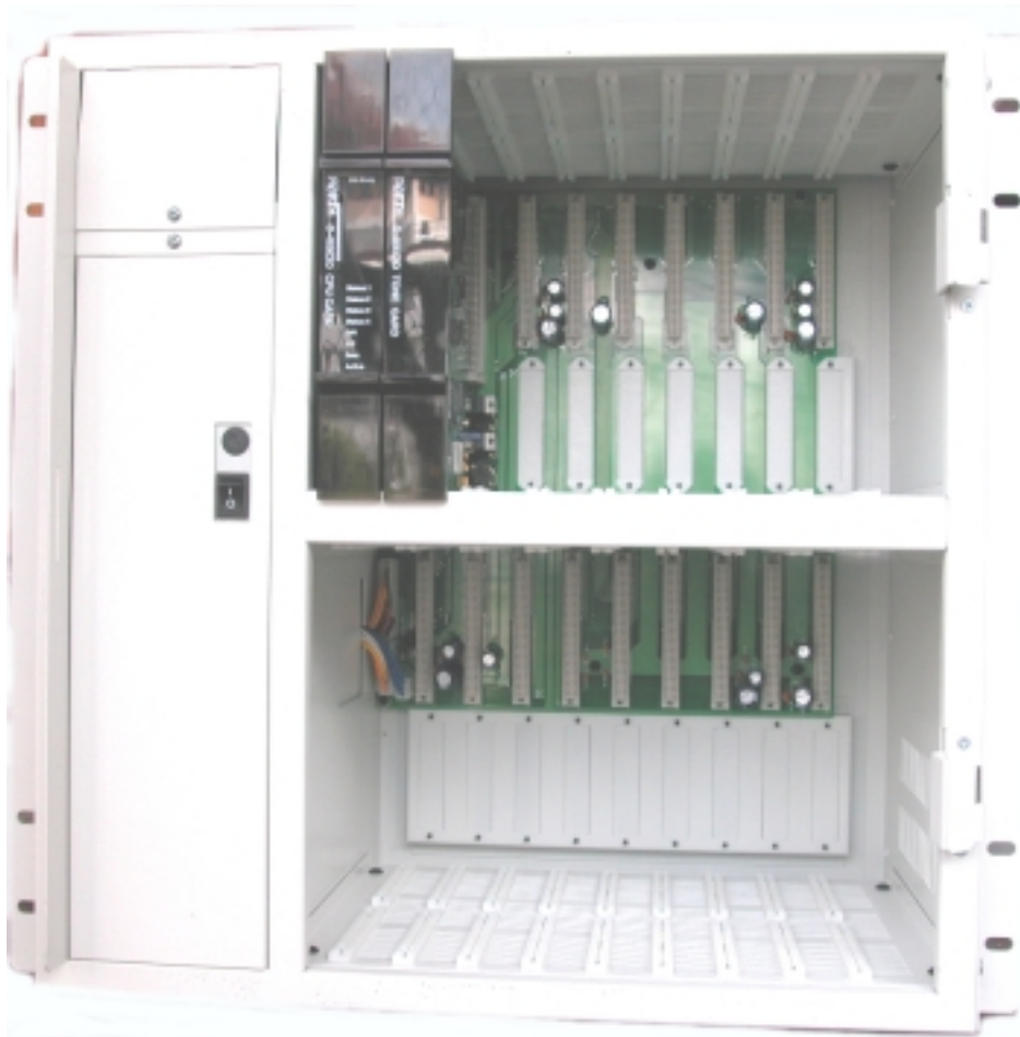
รูปแสดง ลักษณะโครงสร้างภายในของตู้สาขาฯ D-400CID
