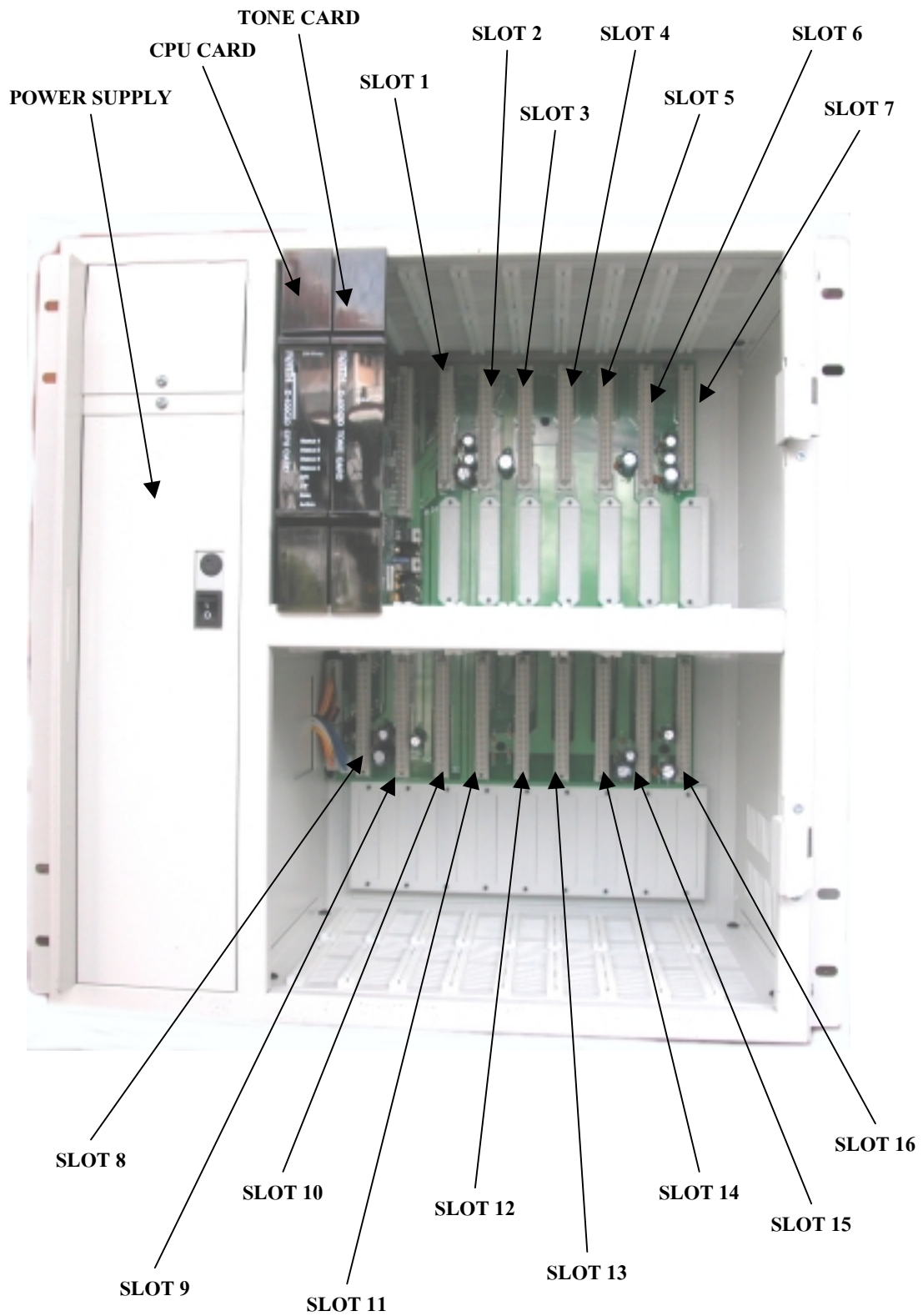
รูปแสดง รายละเอียดการใส่การ์ดบน Main Board
