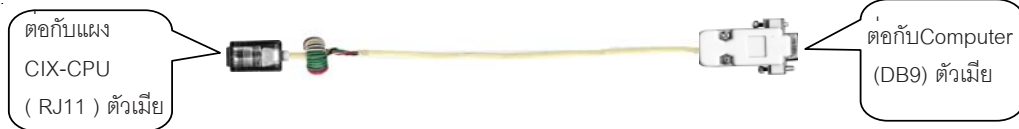
รูปที่ 9.1 ตัวอย่างสายสัญญาณ RJ11 CIX ต่อกับ COM ( DB9 )
